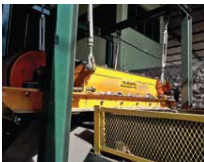
Figura 19: separador magnético e polia magnética trabalhando em conjunto com detectores de metais
